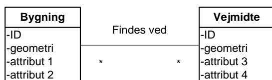
Figur 1.3 Eksempel på et applikationsskema, svarende til en normal, ikke-generisk UML objektmodel for et kortprodukt.
